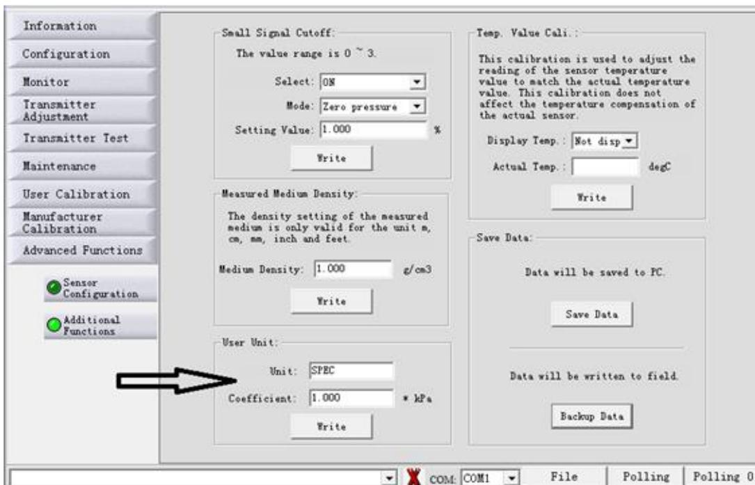
Na caixa "User Unit", apontada pela seta da figura anterior, escreva a unidade de usuário na qual deseja utilizar. Insira o valor do "Coefficient", o qual deverá ser sempre o valor máximo da faixa de calibração dividido pelo valor máximo da faixa de unidade de usuário.
