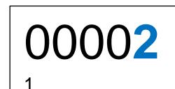
Pressione a tecla **S** para salvar o código de operação. A parte inferior esquerda do display mostrará o código de operação **2** para indicar entrar na função “Configurações da Unidade.”
